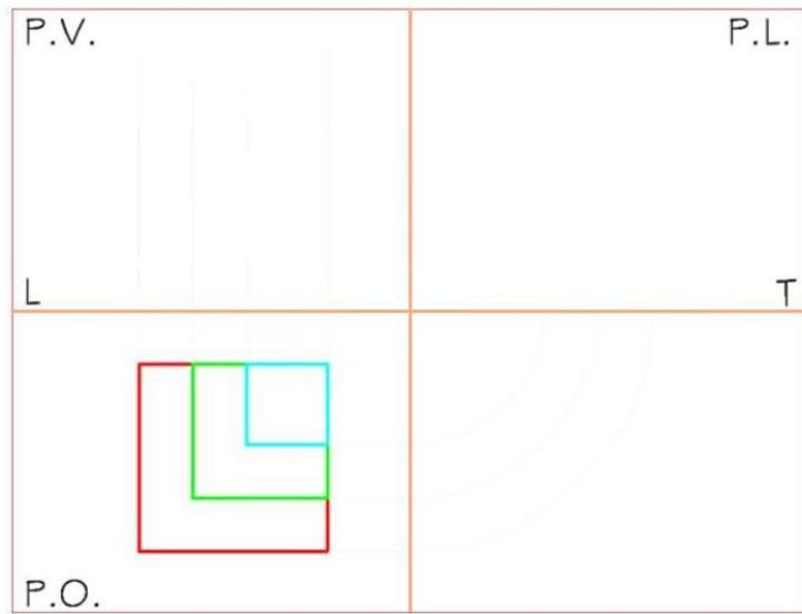
$A = B = 7 \text{ cm}$ ,  $C = 2 \text{ cm}$ ,  $D = 2 \text{ cm}$ . I solidi sono poggiati sul Piano Orizzontale
