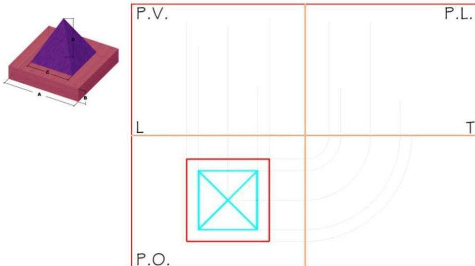
**$A = 8 \text{ cm}$ ,  $B = 2 \text{ cm}$ ,  $C = 4 \text{ cm}$ ,  $D = 6 \text{ cm}$ .** I solidi sono poggiati sul Piano Orizzontale
